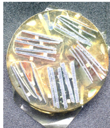
Рис. 2.25. Образцы после испытания на обжим
